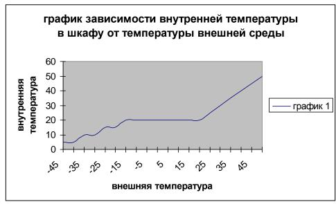
При температуре внешней среды от -5 до - $45^{\circ}$ C работает отопитель. При температуре внешней среды от 20 до + $50^{\circ}$ C работает радиатор с вентилятором.
